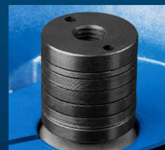
Наборные шайбы регулировки ширины штробы с малым шагом
